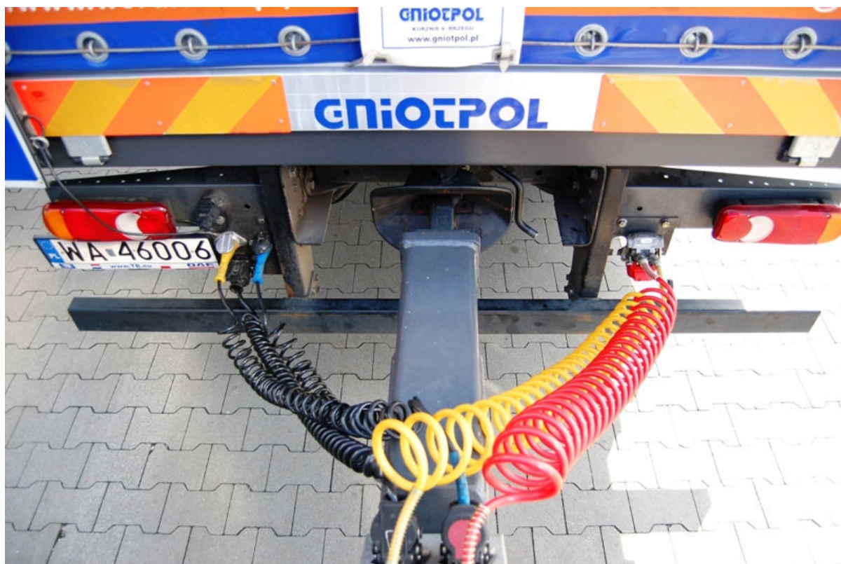
2. Rzut z góry na poprawnie podłączone przewody
