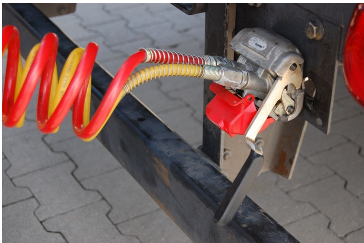
3. Poprawnie wykonane połączenie
